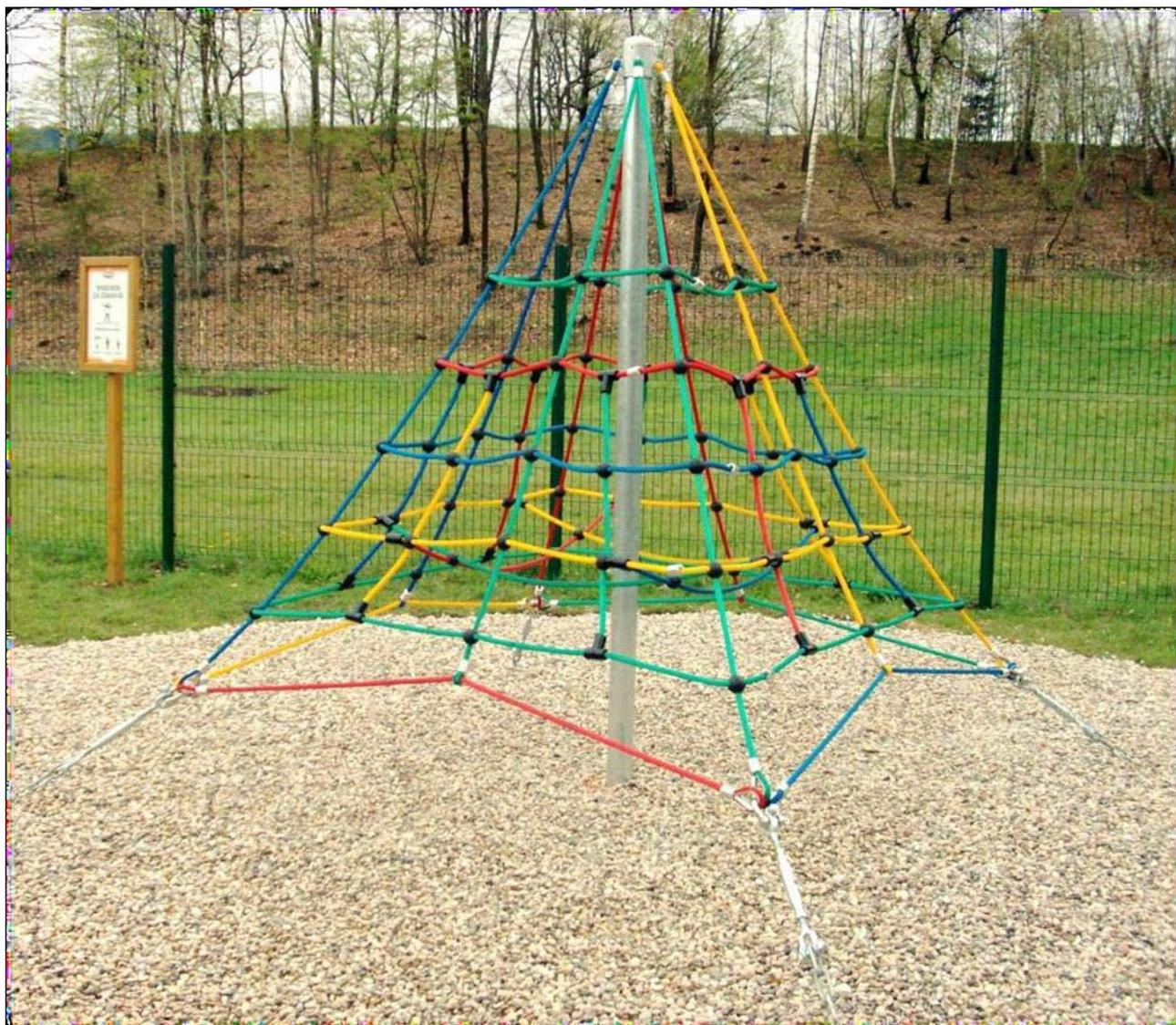
Costruito e certificato in conformità delle Norme Europee EN 1176. Struttura realizzata in corda poliammidica multicolore diametro 16 mm, con anima a 6 trefoli di acciaio.
